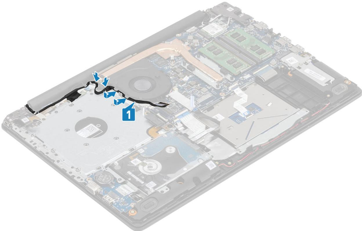
4 Priključite kabel ventilatora, kabel zaslona i ODD kabel na matičnu ploču [1, 2, 3]
