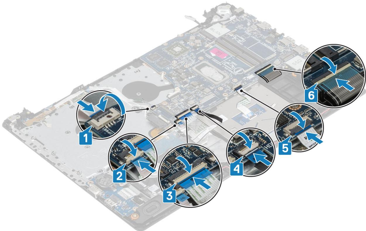
8 Na matičnu ploču [1, 2, 3] priključite kabel ulaza za adapter napajanja, kabel optičkog pogona i kabel zvučnika.
